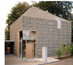
Gabion som tak- och fasadmateri
